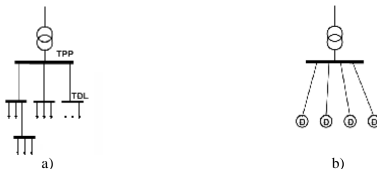
Hình 4.5 - Sơ đồ cấp điện hình tia a) Cho phụ tải phân tán; b) Cho phụ tải tập trung
